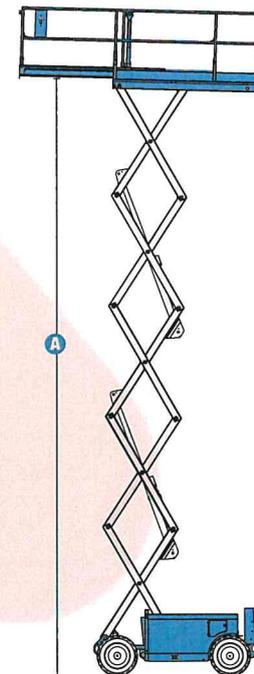
\* Altura de trabajo = Altura de la plataforma + 1,8 m
