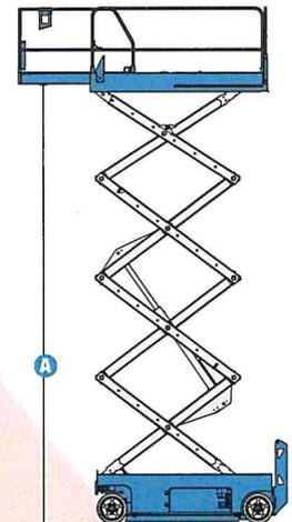
\* Altura de trabajo = Altura de la plataforma + 1,8 m
